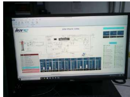
ภาพที่ 2.2-5 ระบบ CEMs ที่ปล่อง SRU1 Incinerator
